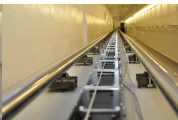
Stanowisko pomiarowe do wzorcowania przyrządów pomiarowych - komparator interferencyjny o zakresie pomiarowym 50 m
