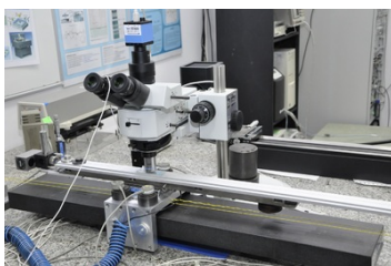
Stanowisko pomiarowe do wzorcowania wzorców kreskowych - komparator interferencyjny
