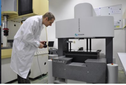
Stanowisko pomiarowe na bazie multisensorowej maszyny współrzędnościowej, wyposażonej w stykową i optyczną głowicę pomiarową
