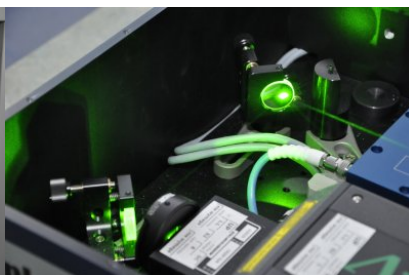
Fragment państwowego wzorca jednostki długości - syntezer częstotliwości optycznych
