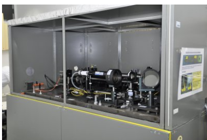
Stanowisko pomiarowe do wzorcowania długich płytek wzorcowych - komparator interferencyjny
