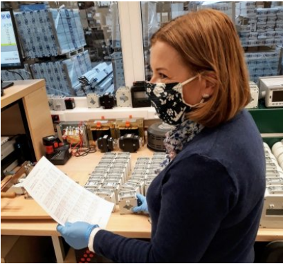
Wzorcowanie przekładników prądowych i napięciowych
