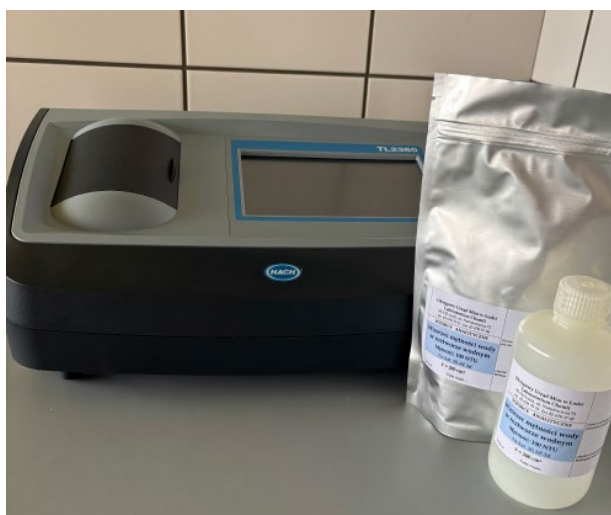
Fot. 10. Stanowisko do pomiaru mętności oraz wzorzec mętności wody
