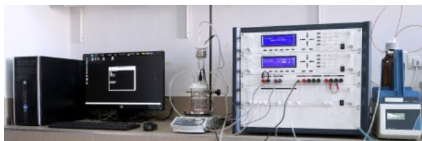
Rys. 2. Stanowisko pomiarowe do wzorcowania pierwotnych materiałów odniesienia jednostki miary ilości substancji w GUM
