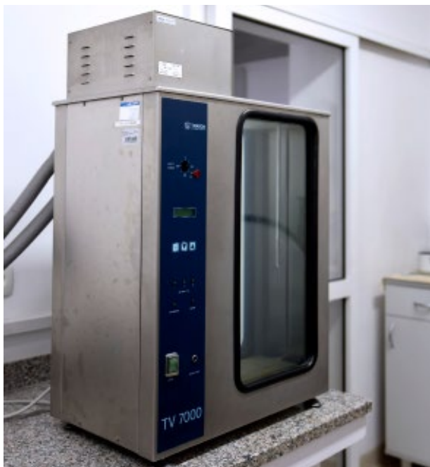
Rys. 5. Stanowisko pomiarowe, nr S03 – do wzorcowania wzorców lepkości cieczy w zakresie temperatur: (25 ÷ 80) °C
