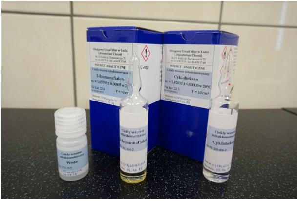
Fot. 15. Ciekłe wzorce refraktometryczne wytwarzane w Okręgowym Urzędzie Miar w Łodzi
