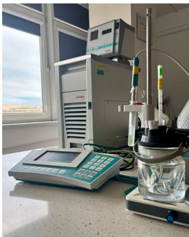
Fot.16. Stanowisko pomiarowe do wzorcowania wtórnych materiałów odniesienia pH za pomocą ogniwa z elektrodą szklaną w Pracowni Wzorców Chemicznych OUM w Łodzi.
