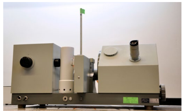
Rys.1. Refraktometr typu Pulfricha
