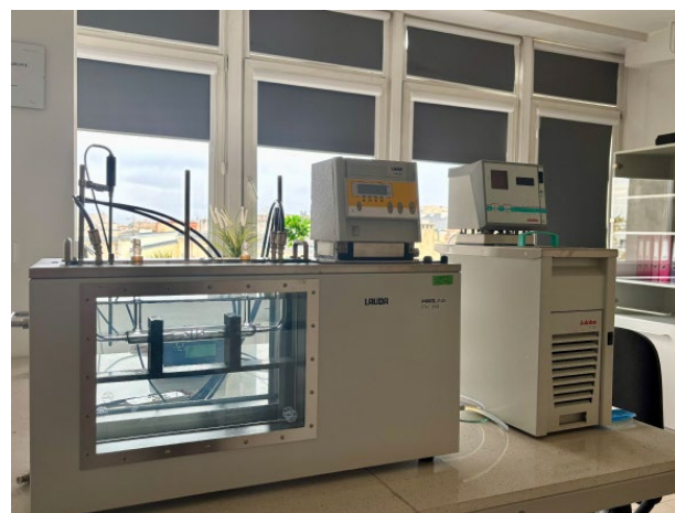
Fot. 17. Stanowisko pomiarowe służące do wyznaczania wartości odtwarzanych przez wtórne wzorce konduktometryczne wytwarzane w OUM w Łodzi.
