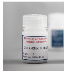
Rys. 4. Pierwotny materiał odniesienia ilości substancji – chlorek potasu
