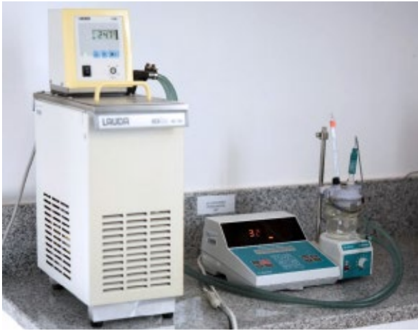
Rys. 1. Stanowisko pomiarowe do wzorcowania wtórnych materiałów odniesienia pH za pomocą ogniwa z elektrodą szklaną w GUM
