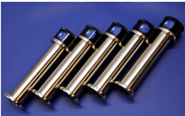
Rys. 2. Państwowy wzorzec jednostki miary kąta skręcenia płaszczyzny polaryzacji światła
