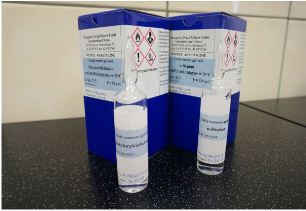
Fot. 13. Ciekłe wzorce gęstości wytwarzane w Okręgowym Urzędzie Miar w Łodzi
