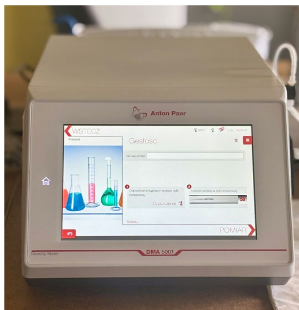
Fot.12. Stanowisko do pomiaru gęstości
