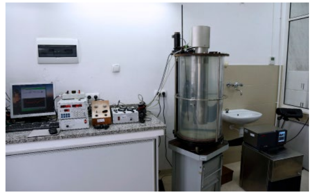
Rys. 4. Stanowisko pomiarowe (S01) wzorca odniesienia jednostki miary lepkości – do wzorcowania wzorcowych wiskozymetrów kapilarnych szklanych i wzorców lepkości cieczy w temp. 20 °C
