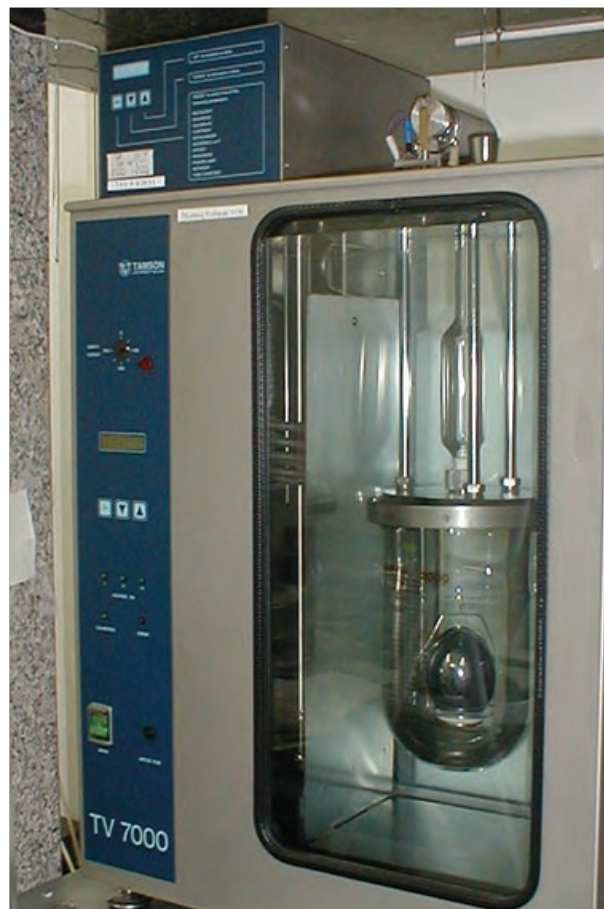
Rys. 6. Wyznaczanie gęstości cieczy na stanowisku ważenia hydrostatycznego
