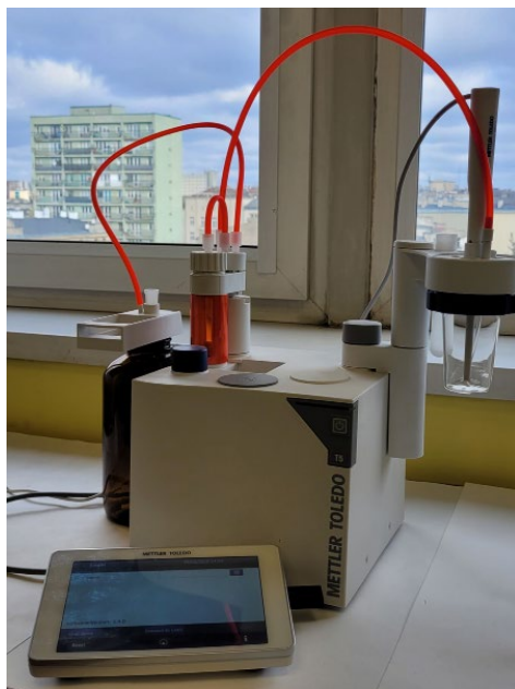
Fot. 3. Stanowisko do miareczkowania potencjometrycznego
