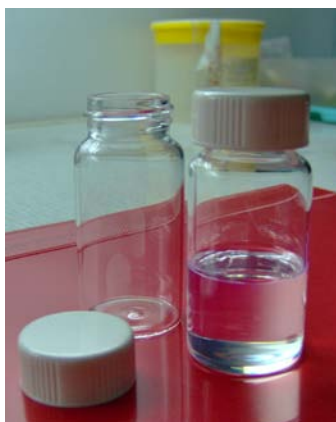
Naczynka pomiarowe wykorzystywane w układach państwowego wzorca JMAPR
