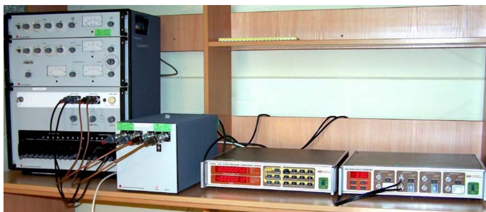
Stanowisko wzorca państwowego pojemności elektrycznej
