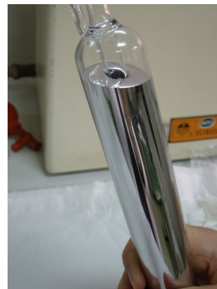
Rys. 2. Komórka punktu potrójnego rtęci wykonana na stanowisku CEM
