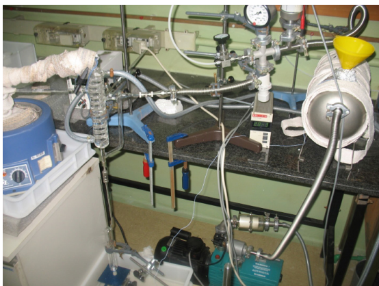
Rys. 1. Stanowisko do produkcji komórek oparte na zasadzie destylacji rtęci
