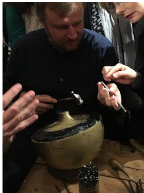
Fot. 4. Cyzelowanie za pomocą puncyn i młotków cyzelerskich
