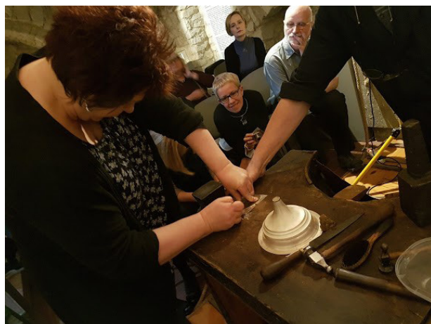
Fot. 2. Wycinanie elementów ze srebrnej blachy do dalszej obróbki
