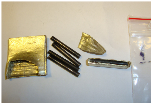
Sztabka złota wypełniona wolframem, który ma taką samą masę właściwą, jak złoto
