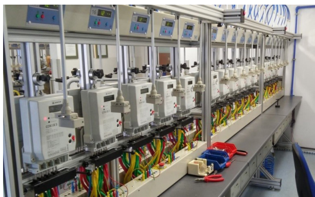
Rys. 2. Widok stacji legalizacyjnej z zawieszonymi licznikami
