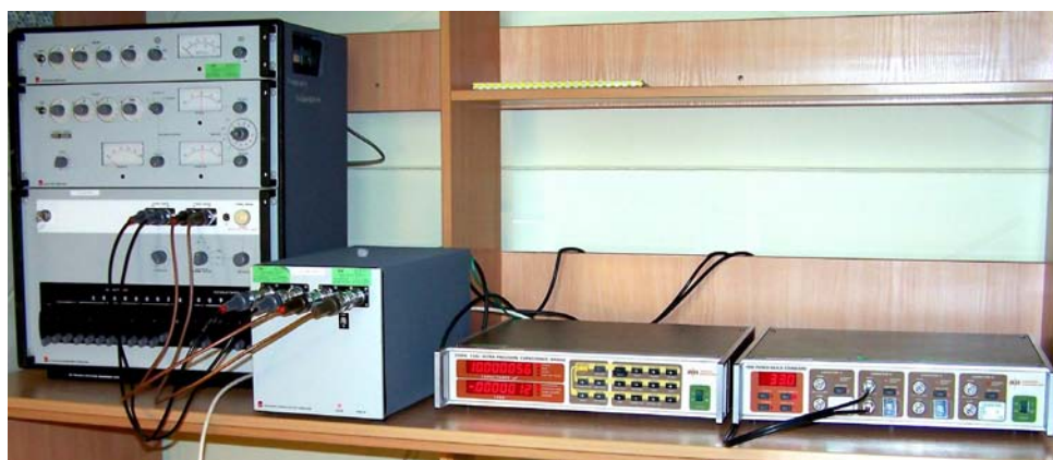
Stanowisko wzorca państwowego pojemności elektrycznej
