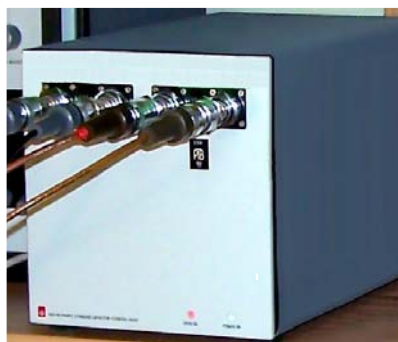
Kondensatory GR 1408 o wartościach nominalnych 10 pF i 100 pF we wspólnej obudowie
