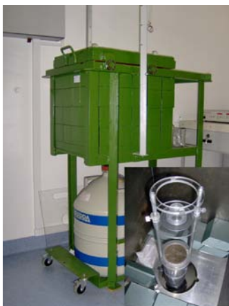
Spektrometr gamma GX2018 z kriostatem i kryształem HPGe
