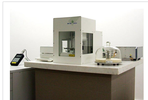
Rys. 5. Państwowe stanowisko do przekazywania jednostki miary masy w GUM
