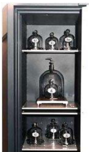
Rys. 1. IPK – platynowo-irydowy wzorzec 1 kg, wraz z sześcioma kopiami przechowywany w BIPM źródło: fot. arch. BIPM
