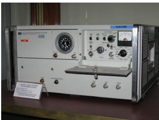
Pierwszy cezowy zegar atomowy w Polsce. Posiada jeszcze 24-godziną tarczę ze wskazówkami. Pracował w Głównym Urzędzie Miar w latach 1976–1995
