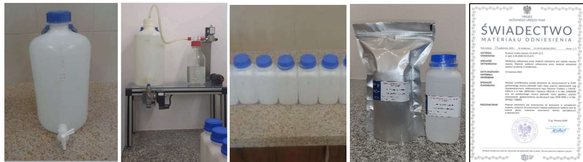
STANOWISKO GUM DO GRAWIMETRYCZNEGO WYTWARZANIA CRM - WODNYCH ROZTWORÓW ETANOLOWYCH
