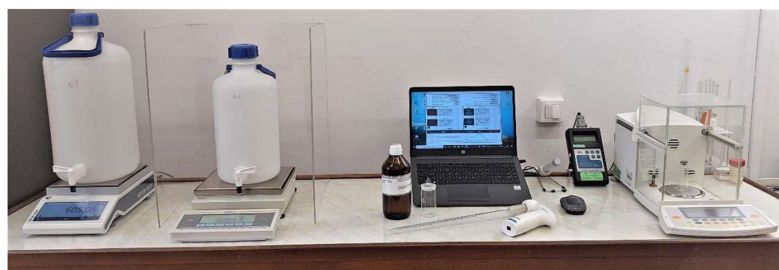
STANOWISKO GUM DO GRAWIMETRYCZNEGO WYTWARZANIA CRM - WODNYCH ROZTWORÓW ETANOLOWYCH
